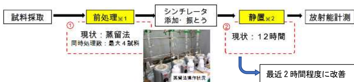
タンク内のトリチウムの濃度測定法
